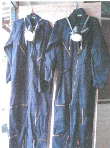
ชุดหมีปฏิบัติงานป้องกันละอองสารเคมี และหน้ากากครึ่งหน้าแบบใส่กรองเดี่ยว ๓ M
